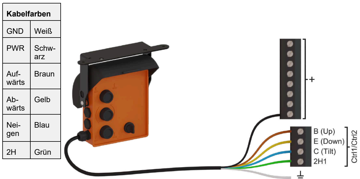
Figure 56 Anschluss von CD3 an ZePRO1
