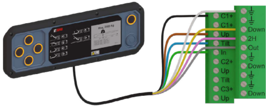
Figure 51 Anschluss von CD19, CD21 an TLC-B1
