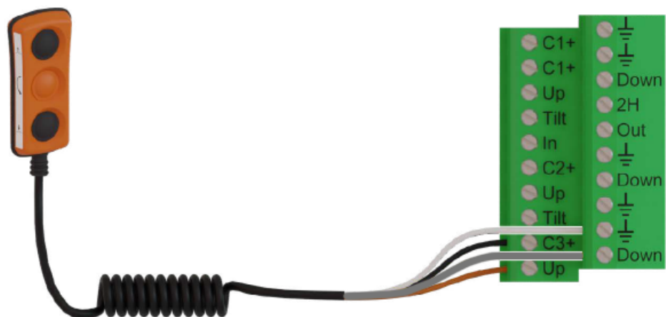
Figure 54 Anschluss von CD10 an TLC-B1
